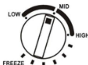
Pour faire baisser la température à l'intérieure de la vitrine, tournez le régulateur dans le sens des aiguilles de la montre. Tournez dans le sens inverse pour faire augmenter la température intérieure.
